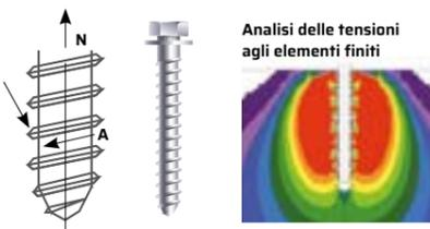
L'indagine pull-out è una prova semidistruttiva per la determinazione della forza di estrazione di un inserto metallico preinglobato o post inserito nell'elemento in calcestruzzo da sottoporre a prova.
