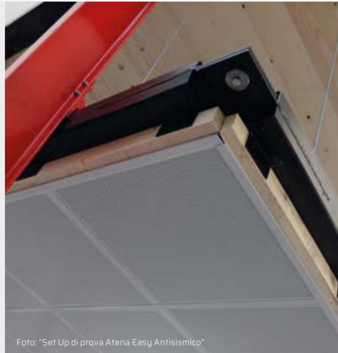
Foto: "Set Up di prova Atena Easy Antisismico"
