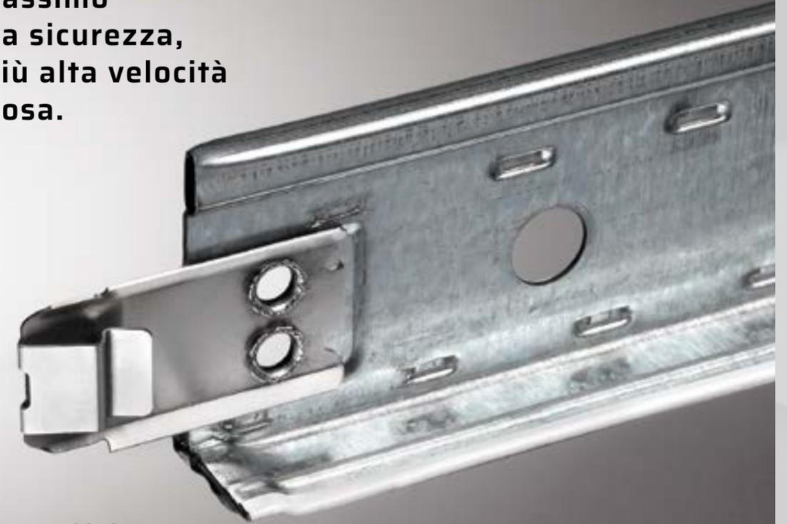
Il gancio **Easy Antisismico**, in acciaio inox, coperto da brevetto internazionale, ha una capacità di **resistenza in trazione pari a 240N**.
