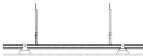
Entrambe le soluzioni possono essere realizzate con **Lastre Diamant®** o con **Lastre Forate Cleaneo®** al fine di migliorare le prestazioni acustiche del solaio.
