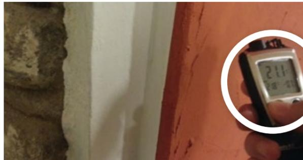
La temperatura superficiale del sistema muffaway® è sensibilmente più elevata (>21° C). La differenza di temperatura è di quasi 2°C e sarà maggiore nel periodo invernale, impedendo la formazione di muffa superficiale e garantendo una piacevole sensazione di parete calda.
